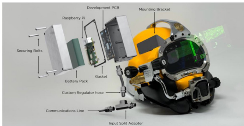
Abb. 13: Entwickeltes, prototypisches AR Gesamtsystem mit Taucherhelm (Quelle: The Imagination Factory Ltd.)
