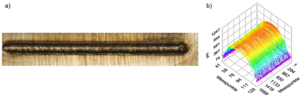
Abb. 3: Mittels Auftragsschweißen erzeugte Schweißnaht (a) und Darstellung der Vermessung der Naht mittels OCT Sensor in einer 3D-Punktwolke (b)
