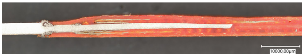
Abb. 3 Querschnitt eines monolithischen FVKs mit integriertem FAUSST-Verbinder.
