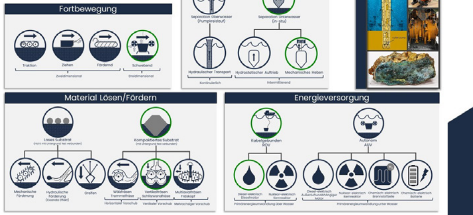
Abb. 3: Technologieanalyse Abbaumethodik und Peripherie für eine minimalinvasive, nachhaltige und selektive Abbautechnologie (verfolgte und mit POC überprüfte Technologien in grün)
