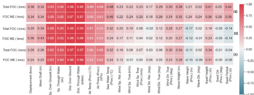
Abb. 4: Korrelationsmatrizen für Daten mit geringer Abtastrate. (1) zeigt die Korrelationsmatrix nach Pearson, (2) nach Spearman und (3) die Distanzkorrelation, (Jabary et al., 2023).
