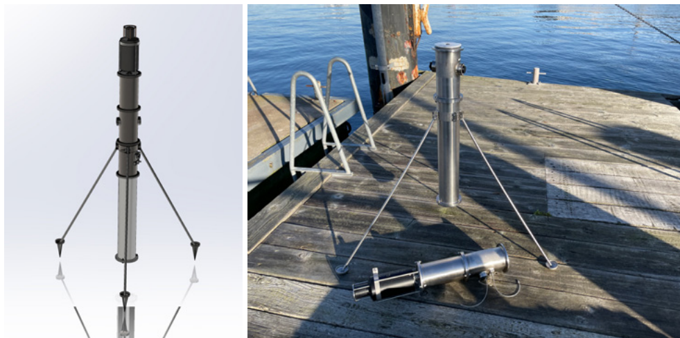
Abb. 10: TOxAR Geräteträger als 3D-Modell sowie während des Nasstests in teilmontiertem Zustand
