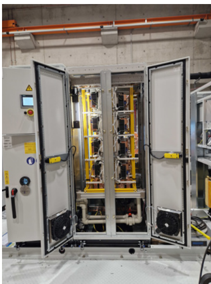
Abb. 6: Finaler Aufbau des DCDC-Wandlers innerhalb des Testsystems
