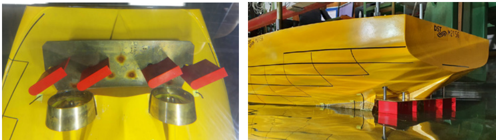
Abb. 10: Unterwasseraufnahme bei gelegtem Ruderwinkel ( \delta = 60^\circ ) und stehenden Propellern (links) sowie Hinterschiff mit ausgetauchten Propellern (rechts)
