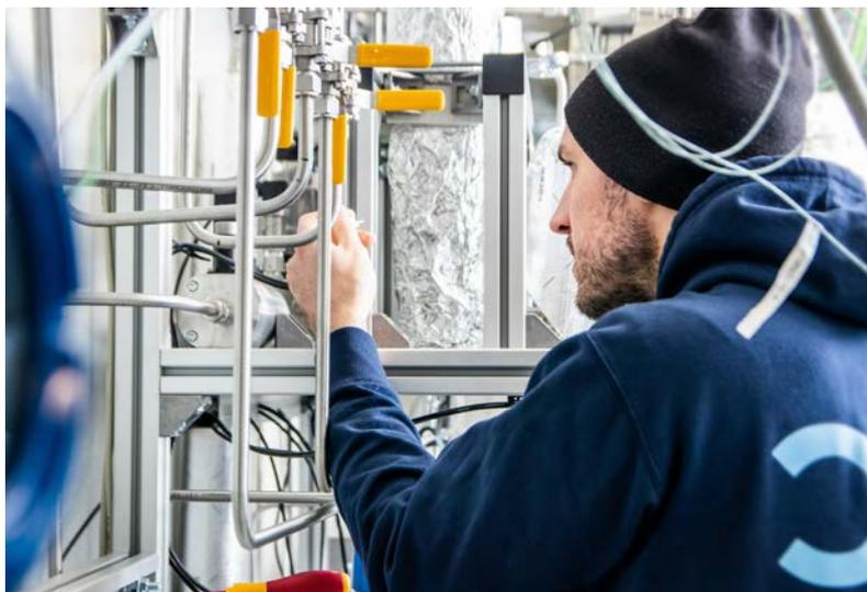
Beim Karlsruher Institut für Technologie (KIT) wird eine weltweit einzigartige Anlage aufgebaut, in der Kohlendioxid aus der Luft abgetrennt und zu Carbon Black für Autoreifen oder Funktionstextilien aufbereitet wird.
