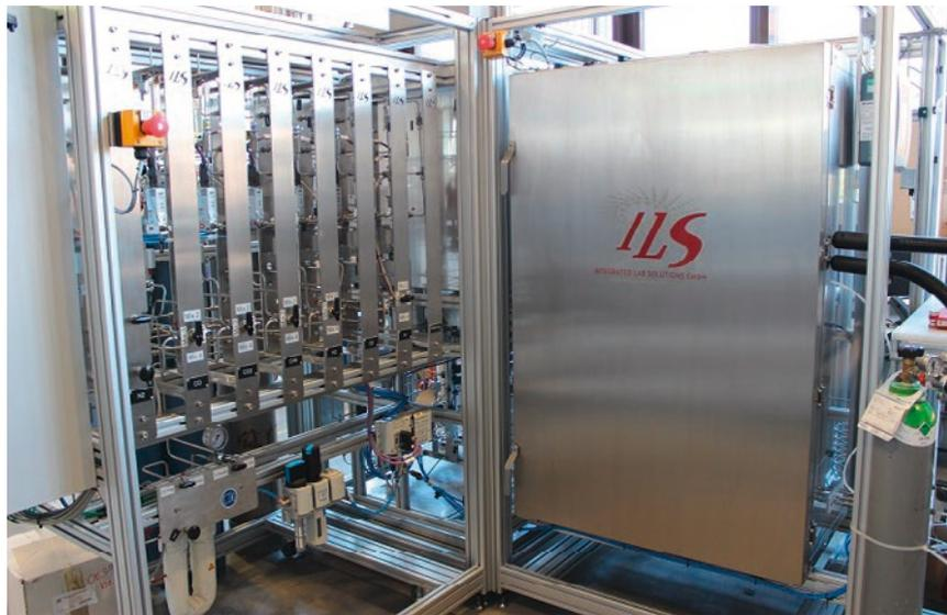
Abb. 2: Katalysator-teststand zur Bestimmung des Methanumsatzes.
