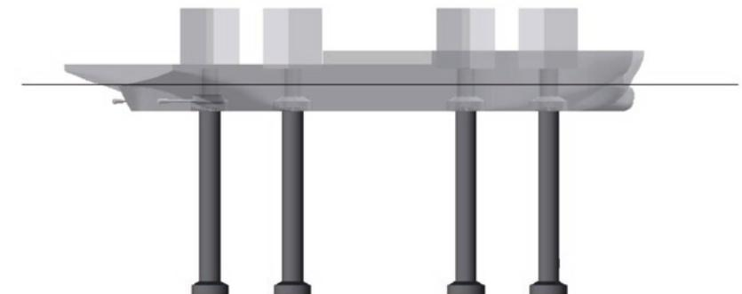
Abb. 5: Errichterschiff mit ausgefahrenen Hubbeinen
