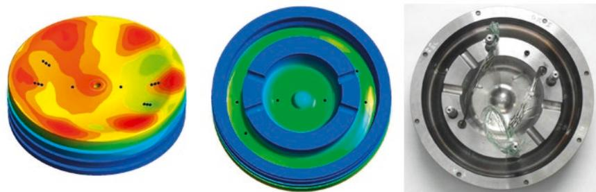
Abb. 15: 20 Messstellen im Kolbenoberteil (links) - 14 Messstellen auf Kolbenboden (Mitte) - 6 Messstellen in Kühlräumen (rechts) - Kolbenoberteil mit Thermoelementen
