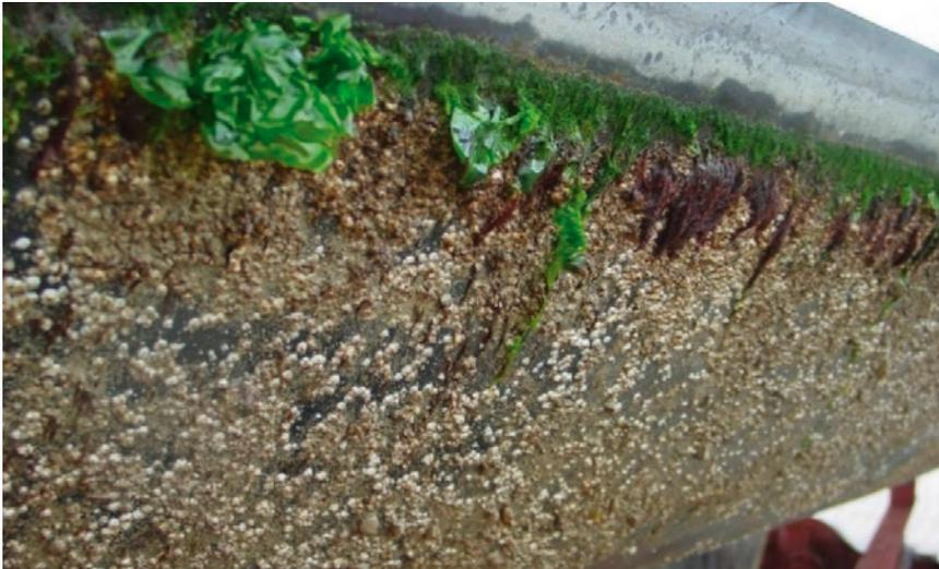
Abb. 2: Bewachsener Schiffsrumpf
