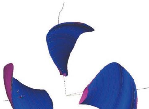
Abb. 8: Tip-Rake Propeller mit zweifach gekippten Profillebenen
