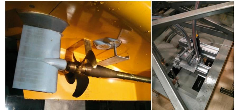
Abb. 12: Nachstrommessungen im Hykat der HSVA - Kalibriertarget unterhalb der Fensterscheiben (links), Zwei Kameras mit Kabelzuführungsschläuchen plus Target-Traversierungsschse tauchbar fixiert im Schiffmodell (rechts)
