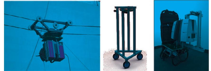
Abb. 8: Verschiedene Varianten der Trägerplattform für den Laserscanner: Seilschlitten, Rollwagen und Rückentrag
