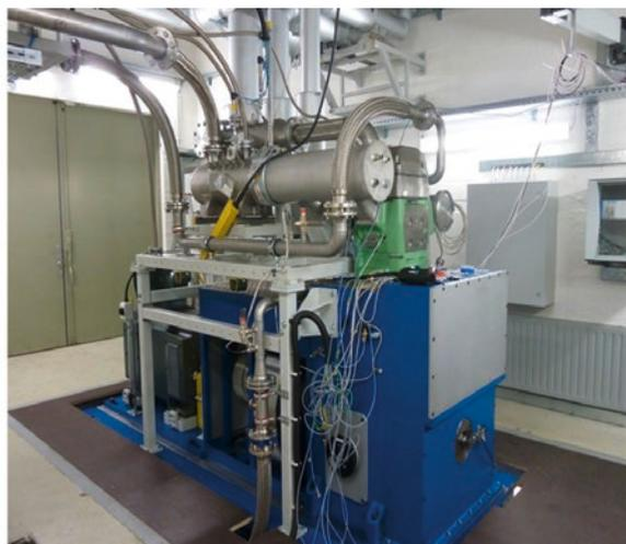
Abb. 12: Einzylinder Forschungsmotor bei Caterpillar Energy Solutions in Mannheim
