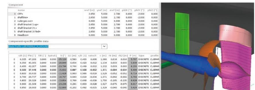
Abb. 3: Gesamtmodell einer Hinterschiffskonfiguration mit Dateninterface für einen Propeller
