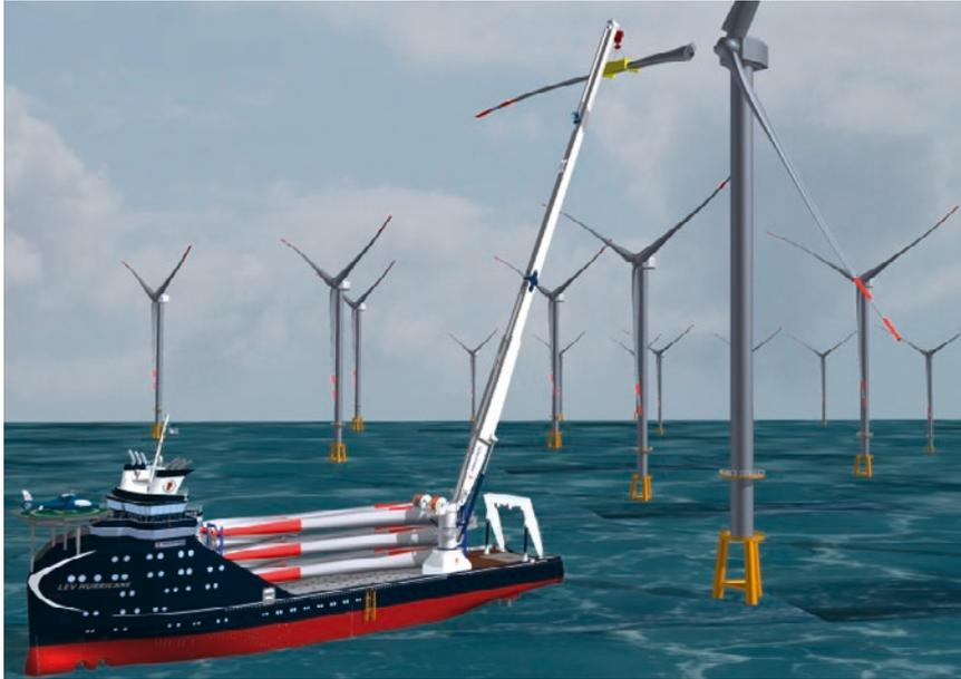
Abb. 3: Rotorblatttausch Offshore mit INNOSHIP, semi-gejackt (Bild: INNOVEN)
