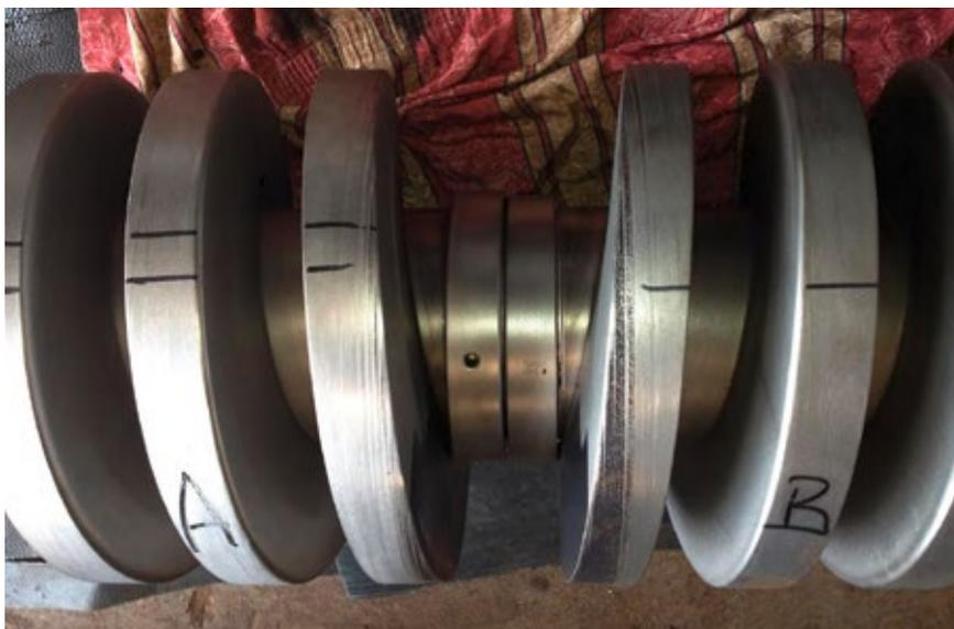
Abb. 6: Rotor mit kombinierten Korrosions- und Erosionsverschleiß
