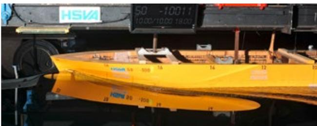
Abb. 6: Propulsionsversuch zur Untersuchung eines optimierten Eisklassepropellers.
