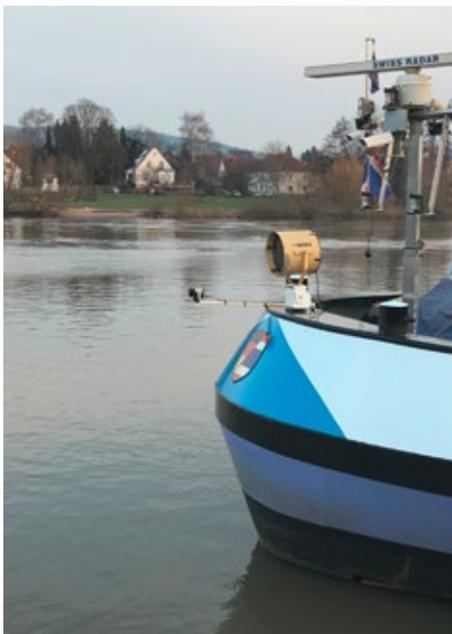
Abb. 8: Montage Laserscanner an einem Erprobungsschiff
