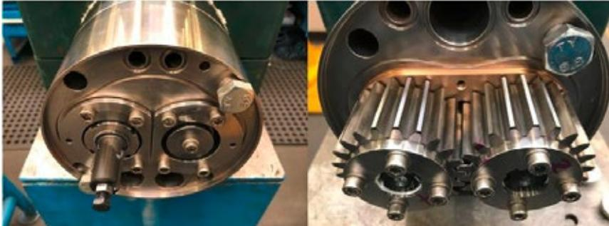
Abb. 2: Antriebs- und Getriebeseite des Pumpenmoduls
