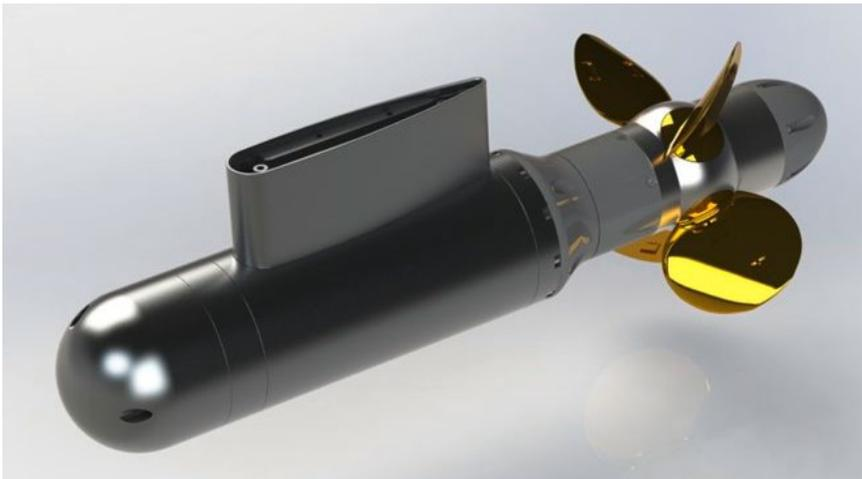
Abb. 13: CPP (mit Rotorblätter, Modell).
