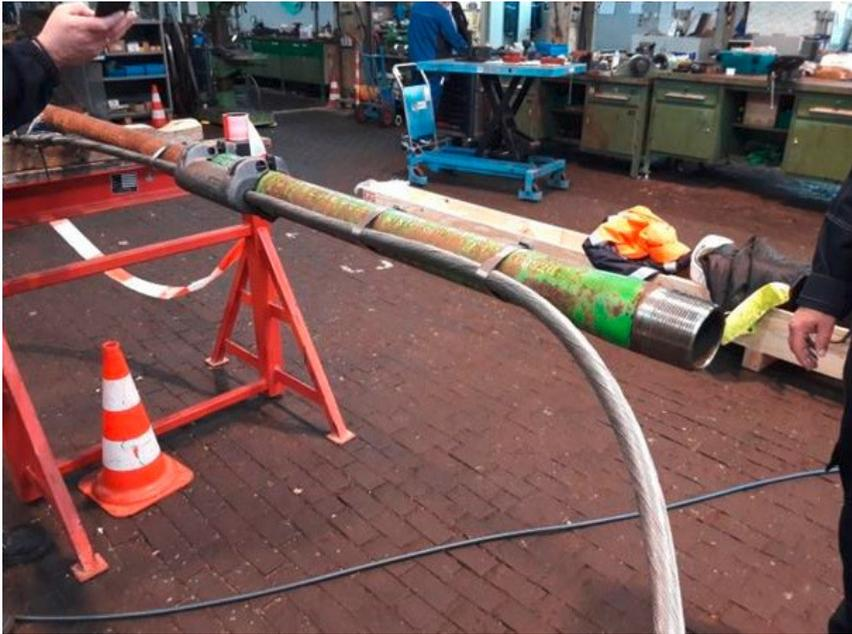
Abb. 8: Yard-Test mit MDA und Zubehör
