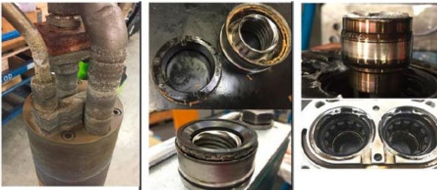
Abb. 5: Inspektion des MDA nach 1000 Betriebsstunden
