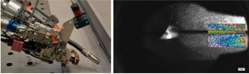
Abbildung 7: a) ShipLight Bearbeitungskopf mit integrierter Fugenfolgesensoren; b) Prozessaufnahme einer Kehlnahtanordnung mit eingblendetem Bereich Region of Interest (ROI) und berechnetem Texturbild (Quelle: Fraunhofer ILT)
