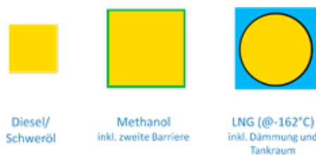
Abb. 4: Platzbedarf Kraftstofftanks an Bord für die gleiche Energiemenge. LNG-Drucktanks sind in einem Tankraum (blau) positioniert. Der effektive Volumenbedarf ist daher in etwa gleich mit Methanol, das drucklos gelagert wird.
