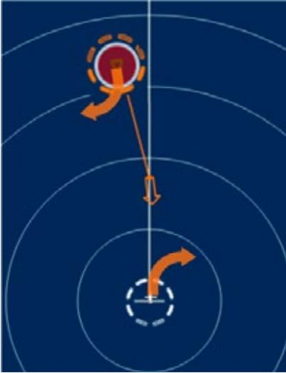
Abb. 10: Verhandlung zwischen zwei Schiffen (unten Eigenschiff, oben Fremdschiff) mit MTCAS. Beiden Schiffen wurde ein Steuerbordmanöver vorgeschlagen. Die rote Fläche im Fremdschiffsymbol signalisiert dem Navigator, dass er ausweichpflichtig ist.
