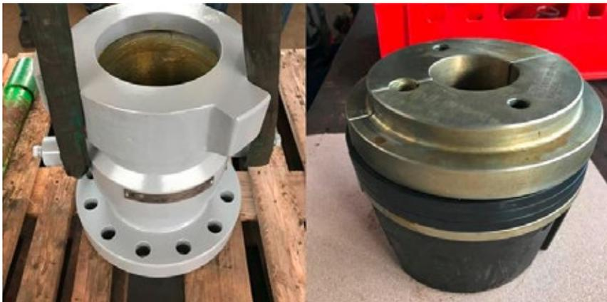
Abb. 9: Well Head mit Klemmvorrichtung, Dichtungen und Spannsystem
