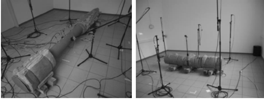
Abbildung 5.1: SEA-Modell bestehend aus Zylinderwand sowie innerem und äußerem Luftvolumen; Anwendung der inversen SEA für die Untersuchung der Kopplung zwischen Struktur- und Fluidschall an einem Rohrelement; oben: schematischer Modell- und Messaufbau; unten: realer Messaufbau
