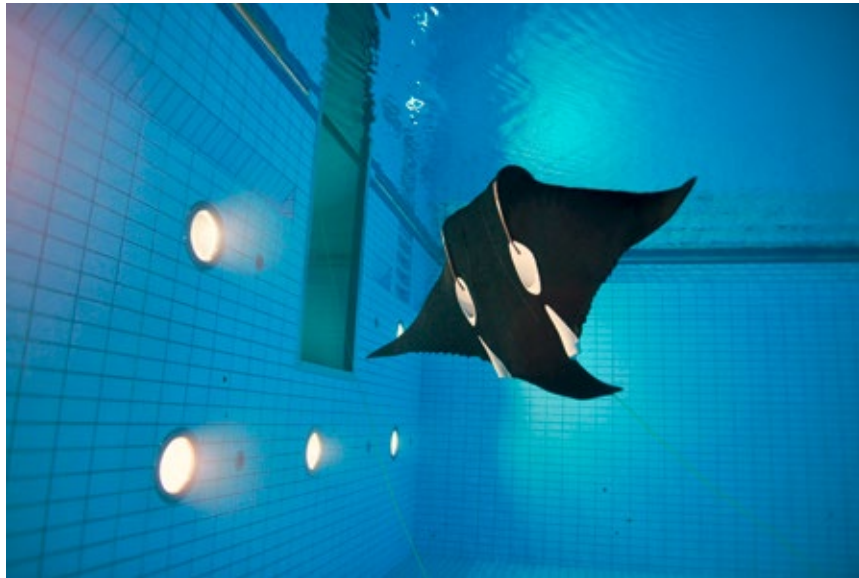
Abbildung 7 : Experimentelle Erprobung und Optimierung des Flügelantriebs mit dem M_0 - Manta im großen Sprungbecken des Olympiazentrums Berlin
