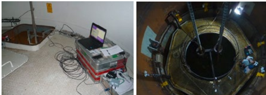
Abbildung 5: Messplatz oberhalb der Grout-Fuge (links) und Blick durch die Luke zur Grout-Fuge mit instrumentiertem Aktor und Sensor (rechts)
