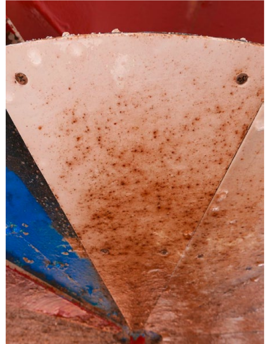
Abbildung 13: Bewuchs auf einer dynamisch am RotoMarin® exponierten Testplatte der Universität Paderborn am 27. Juni 2017.
