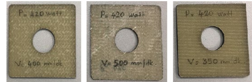
Abb. 8: Mit dem Yb-Laser bei 420 W bearbeitetes GFRP. Vorschubgeschwindigkeit: 400 mm/min, 500 mm/min, 350 mm/min. Materialstärke: 1,2 mm, 1,5 mm, 3 mm.
