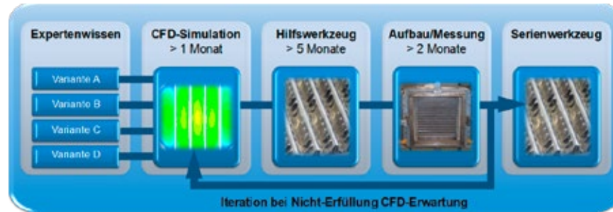
Abbildung 2: Ablauf Wellrippenentwicklung nach Stand der Technik
