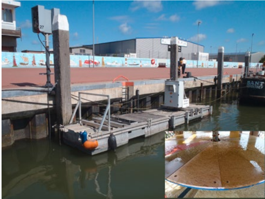
Abbildung 11: LimnoMars dynamischer Antifouling-Testprüfstand RotoMarin® im Norderneyer Hafen und mit Testplatten aus dem Projekt FoulProtect.
