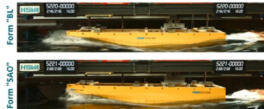
Abbildung 10: Versuchsfotos im Großen Schlepptank der HSVA bei 16 kn Schiffsgeschwindigkeit; oben: Ausgangsform „BL“, unten: Form „SAO“.
