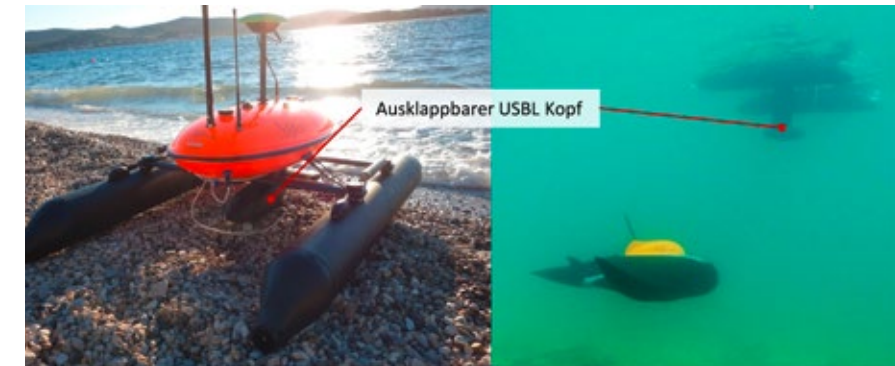
Abbildung 8: Autonome UW-Mission eines bionischen Manta-Fahrzeugs mit Sonobot (ASV) als mitfahrende USBL-GPS-Plattform
