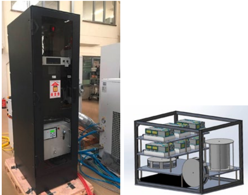
Abb. 3: Links: Vollständiges Lasersystem bestehend aus Faserlasereinheit, Elektronikeinheit sowie Kühleinheit. Rechts: Design der Faserlasereinheit.
