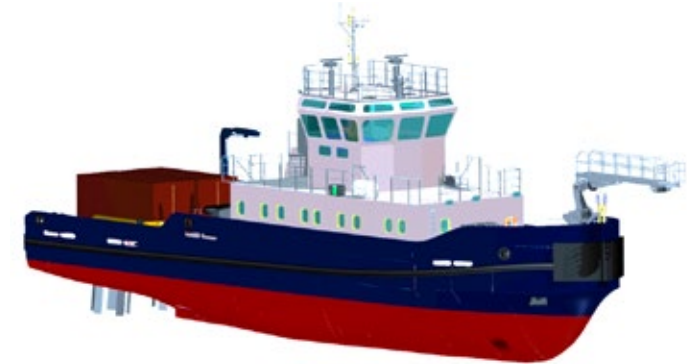
Abbildung 6: Offshore Supply Vessel (OSV) mit Voith-Schneider-Propulsoren zum Transport von Servicepersonal zu Offshore-Windenergieanlagen (Quelle: Voith Turbo GmbH & Co. KG).
