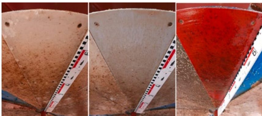
Abbildung 12: Bewuchs auf zwei dynamisch am RotoMarin® exponierten Testplatten von Momentive im Vergleich zum Marktprodukt Hempel's SilicOne am 27. Juni 2017.
