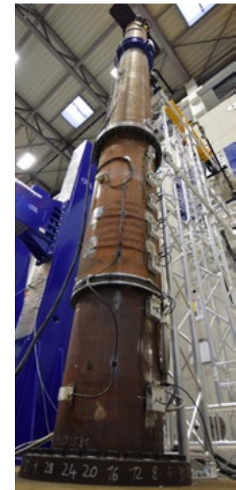
Abbildung 14: Entwicklung der Flächen der 25-kN-Referenz-Hystereseschleifen für TP1 (links oben) und TP2 (links unten) vor und nach der jeweiligen Belastungsstufe von 25 kN, 50 kN, 70 kN und 90 kN am Monopile (rechts) im Spannungsfeld
