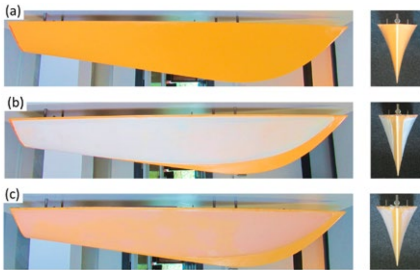
Abbildung 13: Bugsegmente – Blick auf Steuerbordseite (links) und Steven (rechts). (a) Starre Oberfläche – Standardlack; (b-c) nachgiebige Oberfläche mit „Blubberschichtdicken“ von (b) 3 mm und (c) 10 mm
