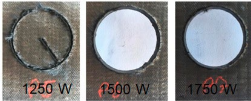
Abb. 5: Bearbeitung von 2 mm starkem CFRP mit Laserstrahlung bei einer Wellenlänge von 1 \mu\text{m} , einer Vorschubgeschwindigkeit von 1000 mm/min und Laserleistungen von 1250 W, 1500 W und 1750 W.
