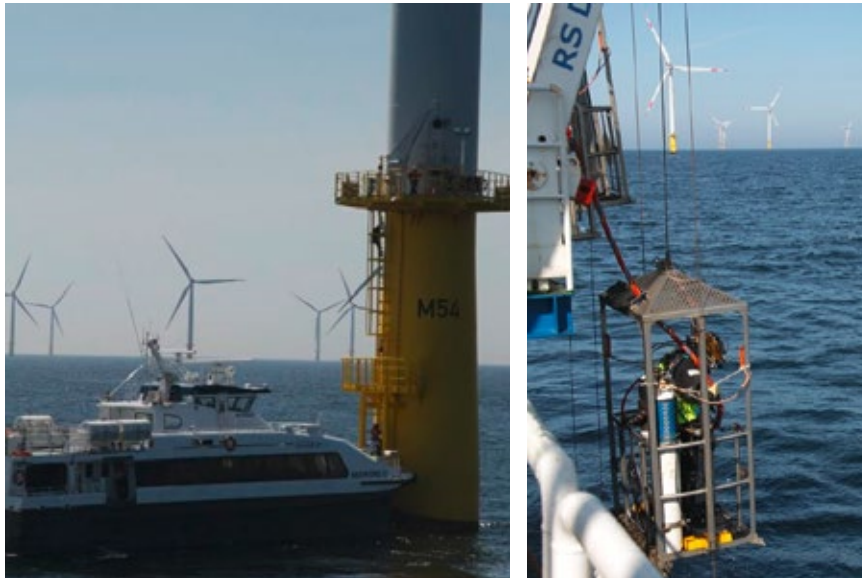
Abbildung 2: Übersetzen der Turmcrew vom CTV (Crew Transfer Vessel) auf die Anlage M 54 (links) und Herablassen des Tauchers im Taucherkorb (rechts)
