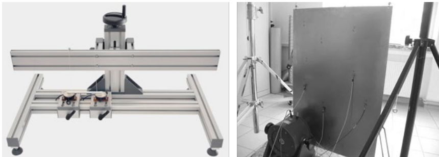
Abbildung 4.1: links: Messaufbau zur Bestimmung des Biegeverlustfaktors nach [1]; rechts: Messaufbau zur Bestimmung der Körperschallnachhallzeit in Anlehnung an [9]
