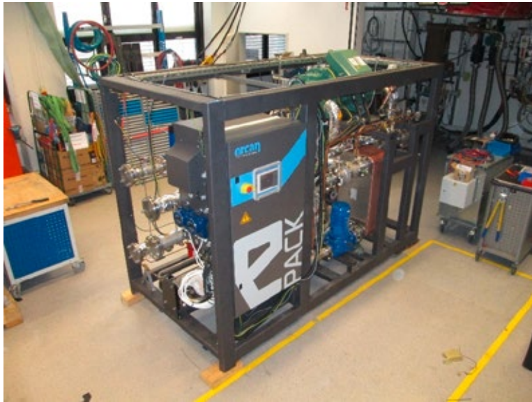
Abbildung 11: ORC-System (Funktionsmuster) nach Montage
