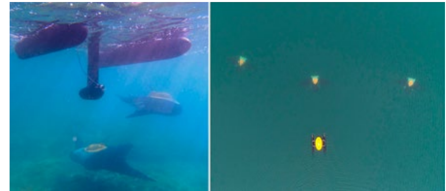
Abbildung 10: Autonome Schwarm-Operation mit 3 Manta-AUVs und einem mitfahrenden ASV; links: UW-Startvorbereitung, rechts: Formationsflug, Luftaufnahme mittels Flugdrohne
