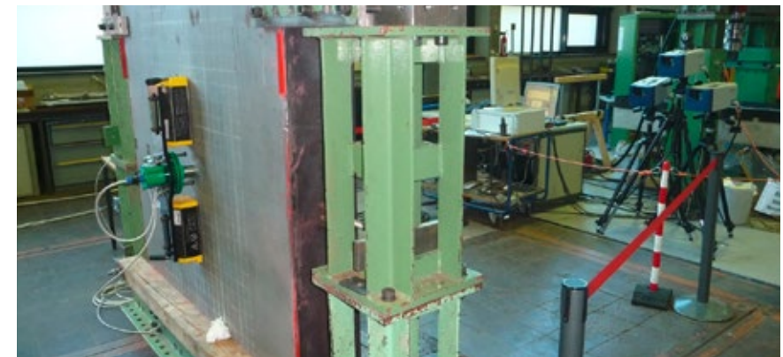
Abbildung 7: Aktor, rechts: Laservibrometer als sensorisches Element
