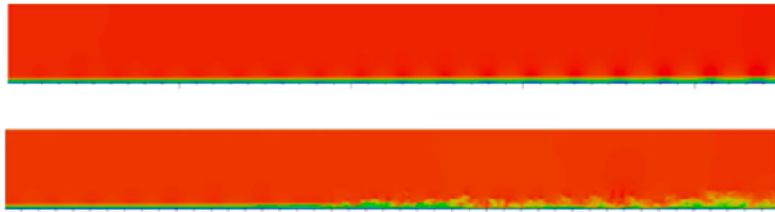
Abbildung 7: Momentangeschwindigkeitsfeld. Einzelne TS-Welle bei störungsfreier Außenströmung (oben). Einzelne TS-Welle bei schwachem „Rauschen“ in der Außenströmung (unten), welches zum Zusammenbruch des laminaren Zustandes und zu vollturbulenter Strömung führt.
