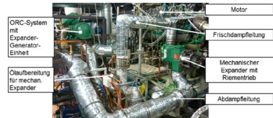
Abbildung 12: Versuchsaufbau ORC-Funktionsmuster mit mechanischer Einkopplung
