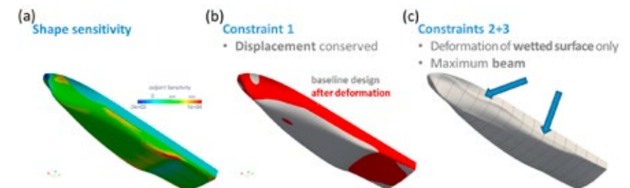
Abbildung 7: Formoptimierung eines OSV (Maßstab 1:9, Geschwindigkeit 15 kn, F_n \approx 0,4 ). (a) Formsensitivität bzgl. Zielfunktion „Glatwassergesamtwiderstand“. (b) Veranschaulichung der Nebenbedingung „Erhaltung der Wasserverdrängung“. (c) Implikationen der Nebenbedingungen „Verformung beschränkt auf benetzten Rumpf“ und „maximal zulässige Breite“.
