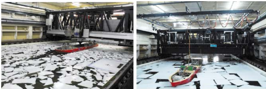
Abbildung 2: Impressionen aus den Versuchen der Phase I; Modell im „Fixed Mode“ (Phase I, Run 5400) (links) und Modell im DP Mode (Phase I, Run ) (rechts), [12]
