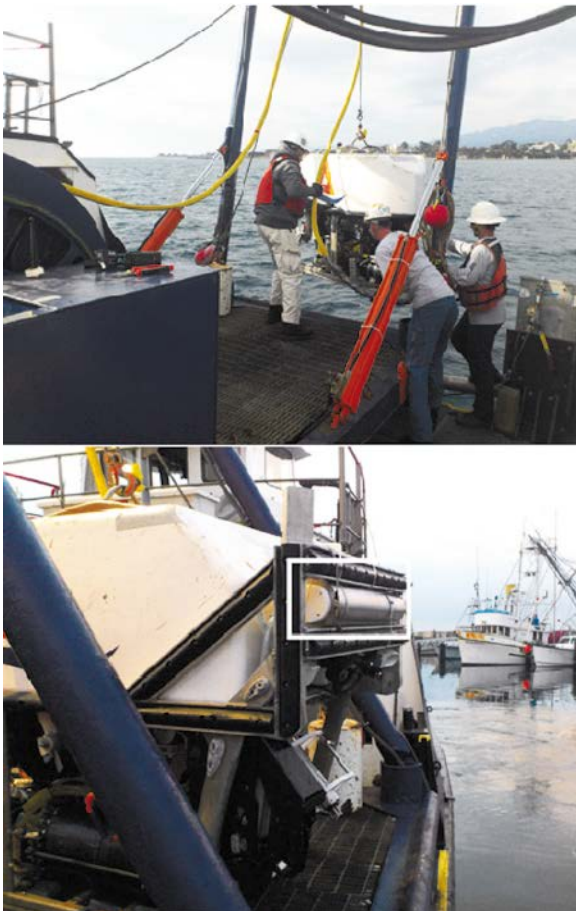
Abb. 4: (a) Einsatz des „HYSUB 20“ ROVs von Steuerbord der M/V Danny C; (b) Die HISEM Sensoreinheit (innerhalb der weißen Umrandung) konnte stossicher hinter dem vorderen ROV-Fänger montiert werden.
