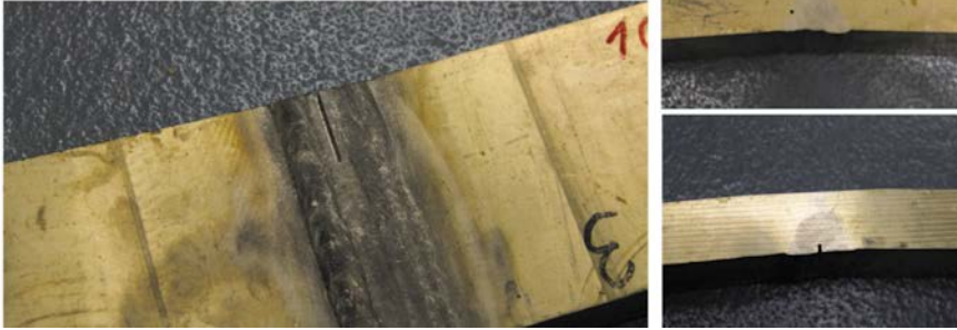
Abb. 9: Testkörper mit Nut und Querbohrung in Schweißnahtflanke und – wurzel.
