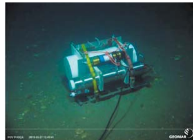
Abb. 9: (a) Zentrale Landereinheit (geeignet auch für Fischereigebiete); (b) HISEM System (Sensoreinheit und Energieversorgung).
