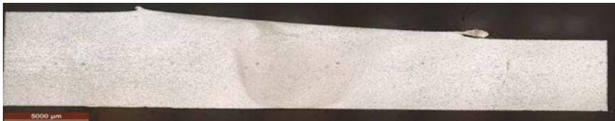
Abbildung 11: Makrographischer Querschliff FSW-Schweißung, Tailored-Plates, mit optimierten FSW Parametern, in Schweißrichtung gesehen (6 / 8 mm)
