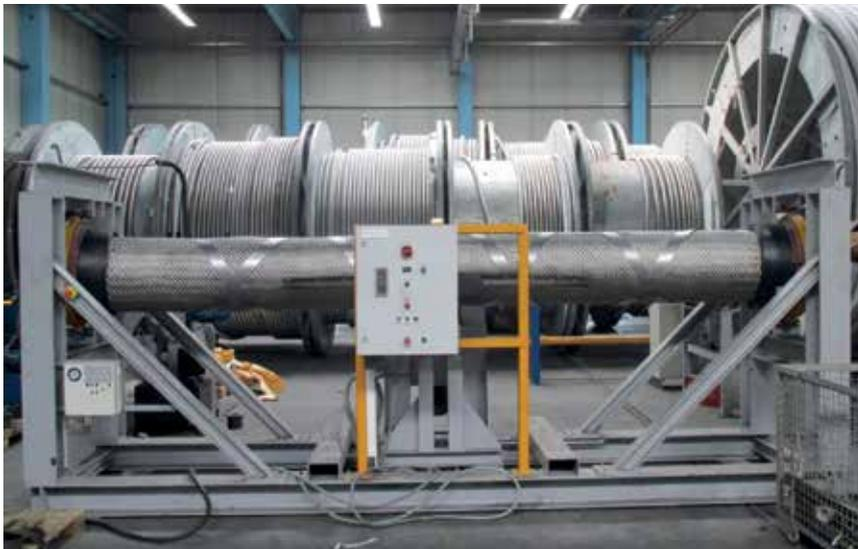
Abb. 9: Versuchsstand für Dauer-Biege-Belastungen
