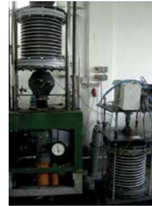
Abb. 10: Prüfstände für axiale Ermüdungsuntersuchungen
