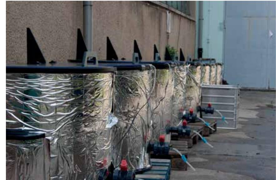
Abb. 6: Rundtanks (eingepackt in Rettungsdecken zur Verhinderung einer unnatürlichen Erhitzung) für Mesokosmenversuche mit integriertem Probennehmer (roter Auslaufhahn) und verschiedenen Messgeräten im Alucontainer
