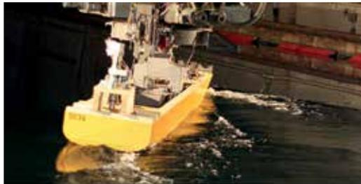
Abb. 1: Modell des Einschraubenschiffes beim gefesselten Versuch.
