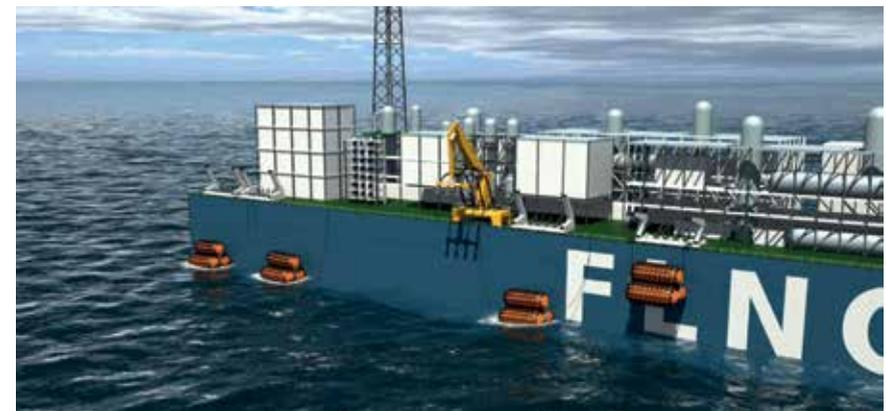
Abb. 1: Das SOTLL Flüssiggastransfersystem in Erwartung des Shuttle-Tankers
