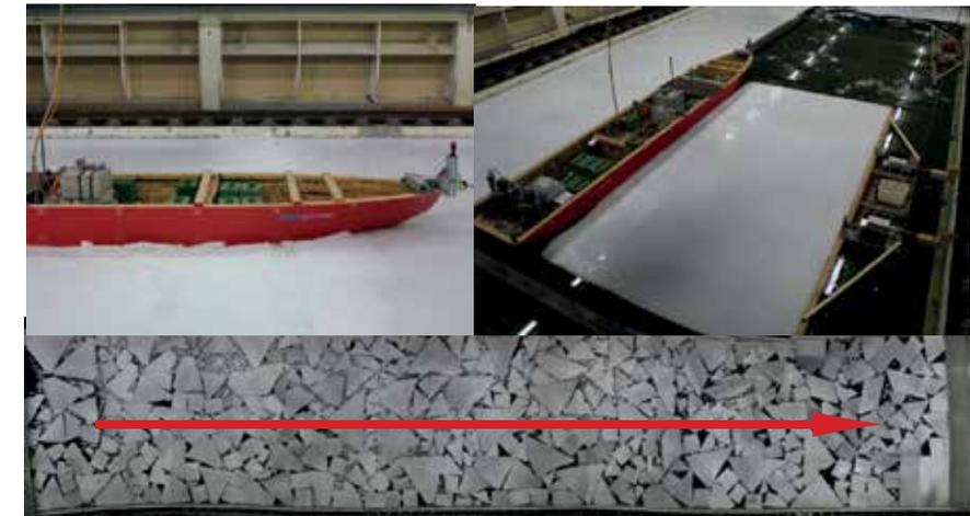
Abb. 7: Modellversuche: Geschwindigkeit in unterschiedlichen Eisbedingungen
