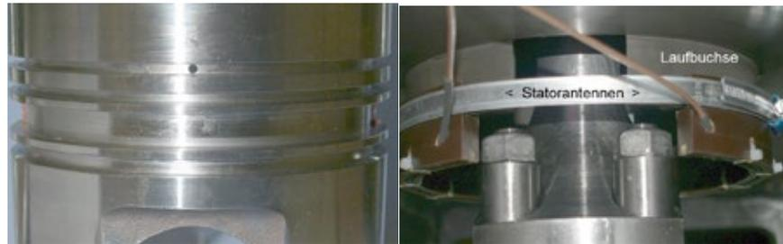
Abbildung 6: Kolben aus MCG3 im Prüfmotor im WTZ
