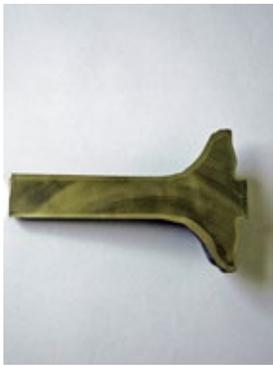
Abbildung 10: Explosivplattierter Grundkörper für ein Schiffsdieselmotor-Ventil
