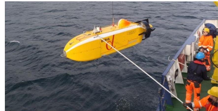
Abbildung 5: AUV 'Doris alpha' während Seeerprobungen (Quelle: Enitech)
