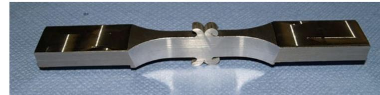
Abbildung 21: Reibschweißprobe mit Wulst
