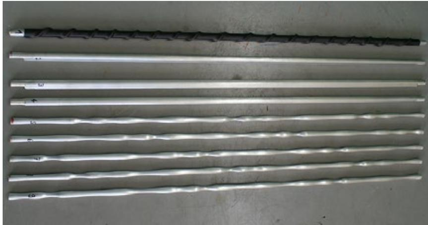
Abbildung 9: Prüfstäbe zur Vermessung der Optimierung von Kabeloberflächengeometrien.
