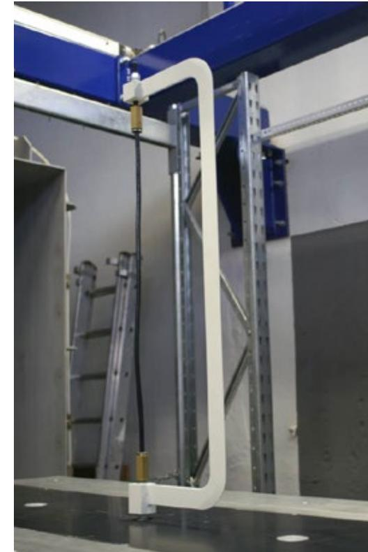
Abbildung 8: Messrahmen mit eingespanntem Musterkabel im Windkanal
