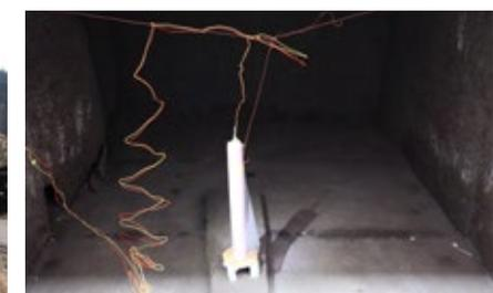
Abbildung 9: Versuchsaufbau, präpariert zum Explosivplattieren von rohrförmigen Bauteilen
