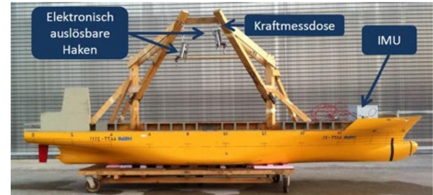
Abbildung 8 : Schiffsdodell für die Versuche mit abreißender Kranlast
