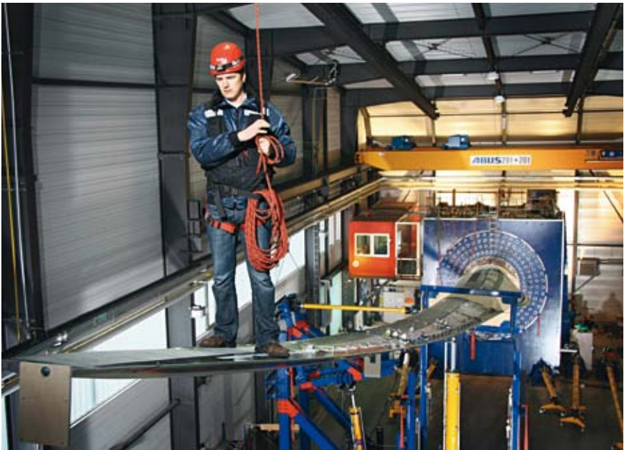
Tests am Rotorblattteststand, Fraunhofer IWES Bremerhaven
