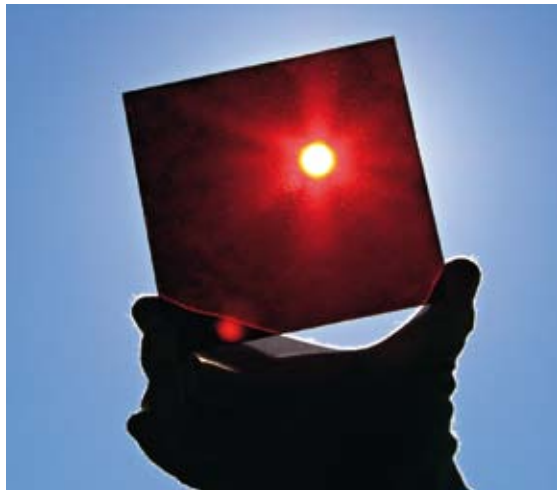
Lichtabsorption einer mit dünnem amorphem Silicium beschichteten Glasplatte
