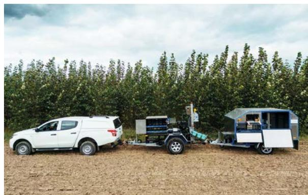
RapidProfiler-Sensorplattform für das Scannen von Bodenprofilen
