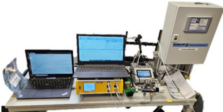
Abb. 5: Versuchsaufbau (Setup) mit GasMOS- H 2 Prototyp (rechts) beim LKV- Rostock
