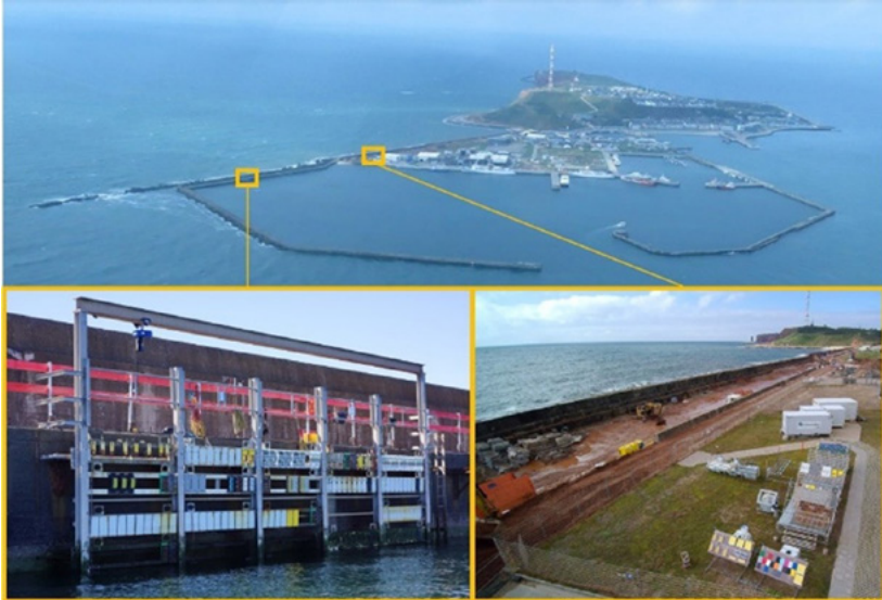
Abb. 13a: Mehrwasser-Auslagerungsprüfstand und atmosphärische Bewitterung auf Helgoland
