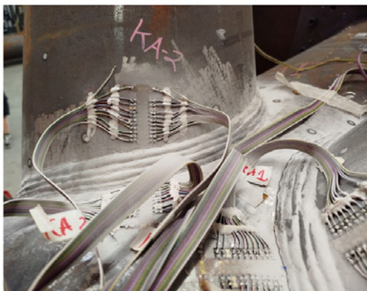
Abb. 7: Großproben (a) und Großversuchsprüfstand (b) des ausgewählten Doppel-Y-Knoten im Labor der TUHH. Die gut sichtbaren weißen Bereiche an den Schweißnähten stammen von den Geometriescans und der Vorbereitung der DIC Messungen. (c) Nahaufnahme der Schweißnähte des Großversuchsrohrknotens mit deutlich erkennbarer Instrumentierung durch Dehnmessstreifen und Rissen entlang der Schweißnähte. (d) Prüfstand für mehrachsige Beanspruchung von Rohr-Flansch-Verbindungen unter Biegung und Torsion inklusive kamerabasiertem Schweißnahtmonitoring zur Anrisserkennung mithilfe von DIC am Fraunhofer LBF.
