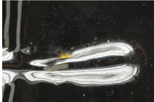
Abb. 16: Aufgesetzte Messzelle in der Mitte und entfernte Messzelle Oberhalb (links). Bilder von dem Defekt der bei den EIS Messungen beobachtet wurde.
