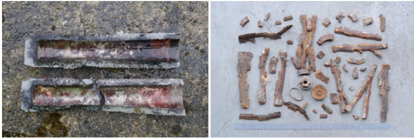
Abb. 4: Probekörper nach erfolgreicher Deflagration (links) und gesprengter Probekörper (rechts) (Quelle: LZH)
