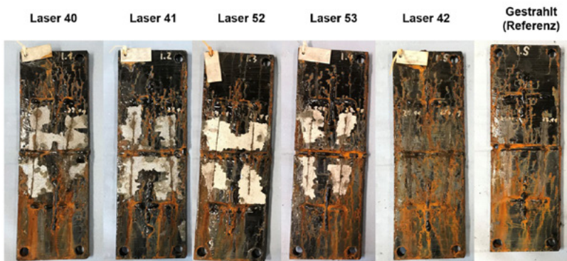
Abb. 13: Lackhaftfestigkeit verschiedener laservorbehandelter Oberflächen im Vergleich zu einer gestrahlten Referenz nach 1000 h Salzsprühtest
