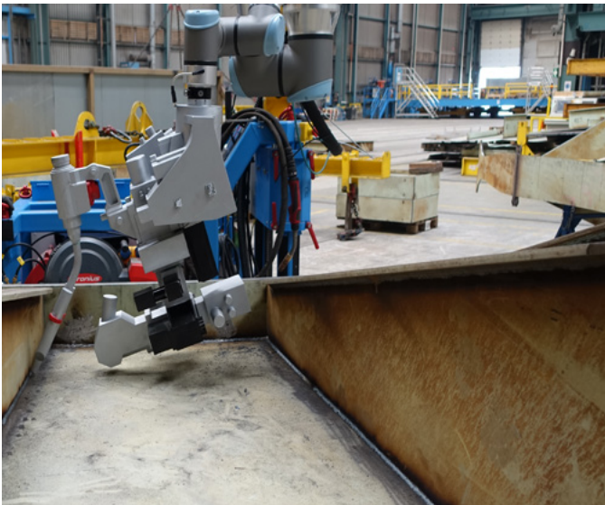
Abb. 5: Zugänglichkeitsuntersuchungen mit dem flexiblen Automatisierungssystem an Bauteilen im Sonderschiffbau der MEYER WERFT
