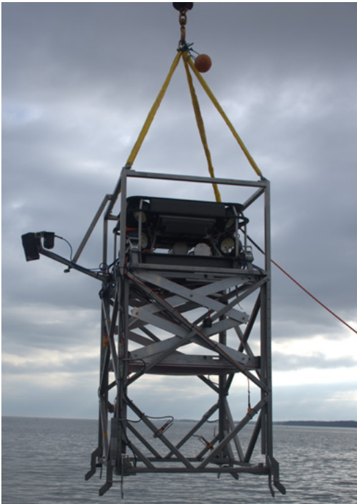
Abb. 5: Bergetool für die standardisierte Bergung und Zuführung von Munition zur Entsorgungsplattform beim Seetest
