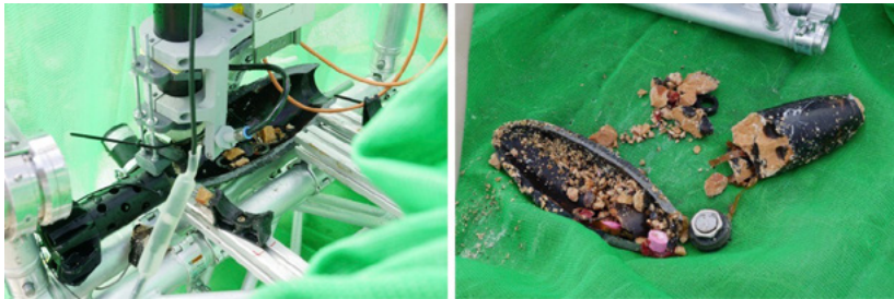
Abb. 7: Ergebnis einer erfolgreichen laserinduzierten Deflagration an einer Mörsergranate (Quelle: LZH)
