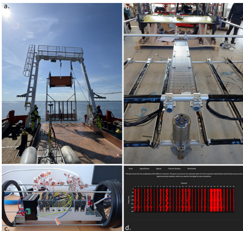
Abb. 2: a: Einsatz des Demonstrators während der zweiten Messausfahrt in der deutschen Ostsee, b: Rahmen mit montierten Hydrophonen und Positionierungssystemen, c: Registrierapparatur, d: Webinterface mit Echtzeitvisualisierung der Daten
