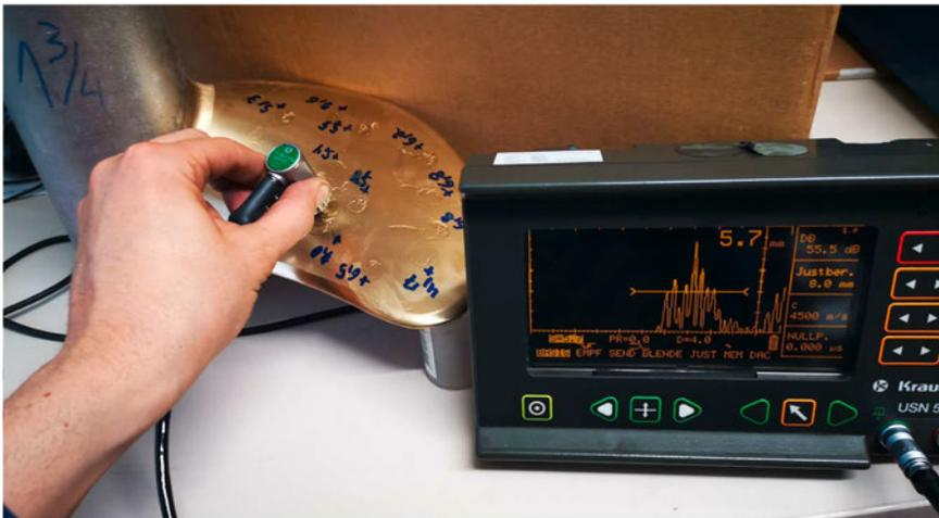
Abb. 11: Ultraschallprüfung des geschliffenen LPA-Propellerblattes
