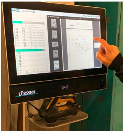
Abb. 8: Arbeitsplatz-PC mit integriertem Touchdisplay
