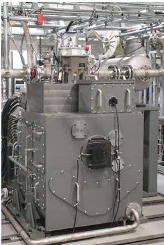
Abb. 7: Einzylinder-Forschungsmotor FM18. Quelle: Stenzel et al., 2022 [7]
