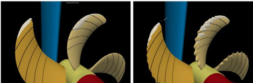
Abb. 15: Mit CFD berechnete Kavitation am Propeller ohne (links) und mit (rechts) Vorderkantenmodifikation.
