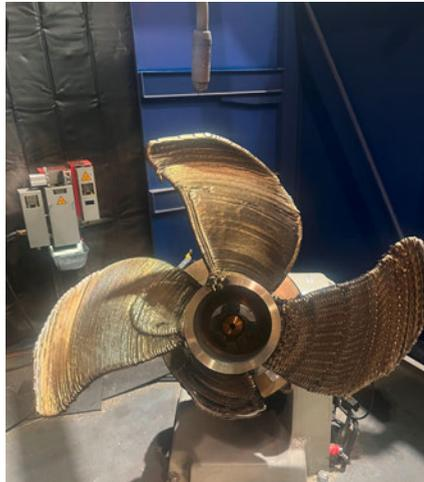
Abb. 3: Erprobung unterschiedlicher Werkzeugbahnen zum Auftragsschweißen in der Versuchsanlage bei der MMG
