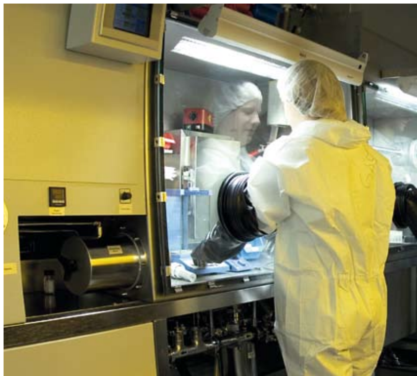
Im Handschuhkasten werden organische Bauelemente hergestellt.
