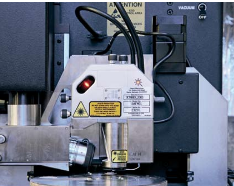
Ein Blick in die Nanoebene: Mit dem Scankopf eines atomaren Kraftmikroskops ist es möglich.
