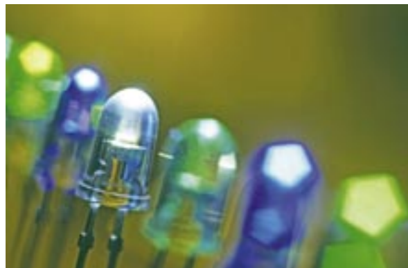
Leuchtdioden glänzen durch kleine Abmessung, Unzerbrechlichkeit und eine lange Lebensdauer.
