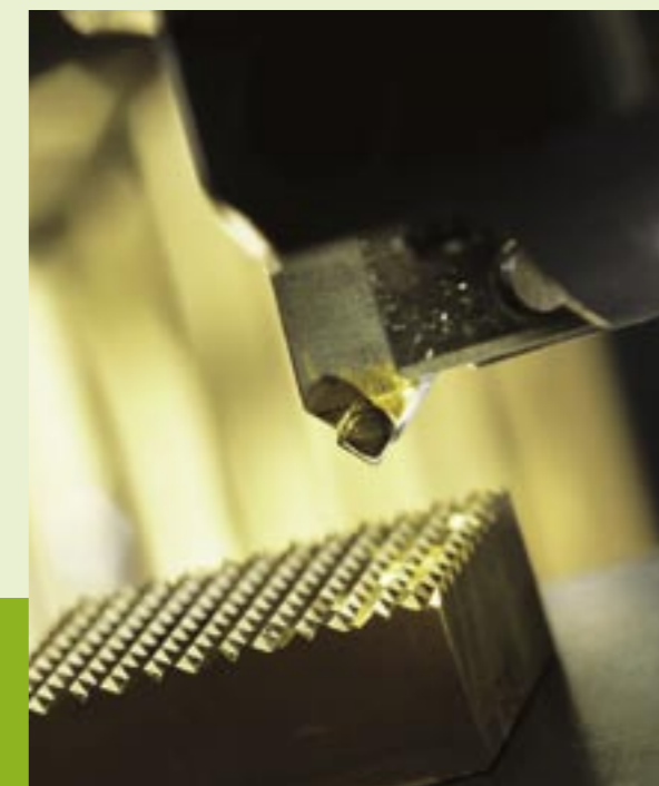
Mittels Ultrapräzisionstechnik werden mikrostrukturierte Oberflächen hergestellt.
