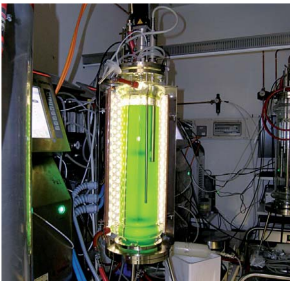
In speziellen Photobioreaktoren wird die Grünalge Chlamydomonas reinhardtii kultiviert. Der innere Kernzylinder mit den grün leuchtenden Algen ist von einem Mantel aus Leuchtdioden (LEDs) umgeben, die der Belichtung dienen. Für das Foto wurde der LED-Mantel geöffnet, um den Kernzylinder zu zeigen.
