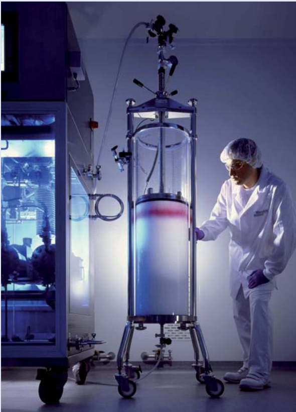
Chromatographische Aufreinigung von Erythropoietin (EPO) in der pharmazeutischen Industrie.
